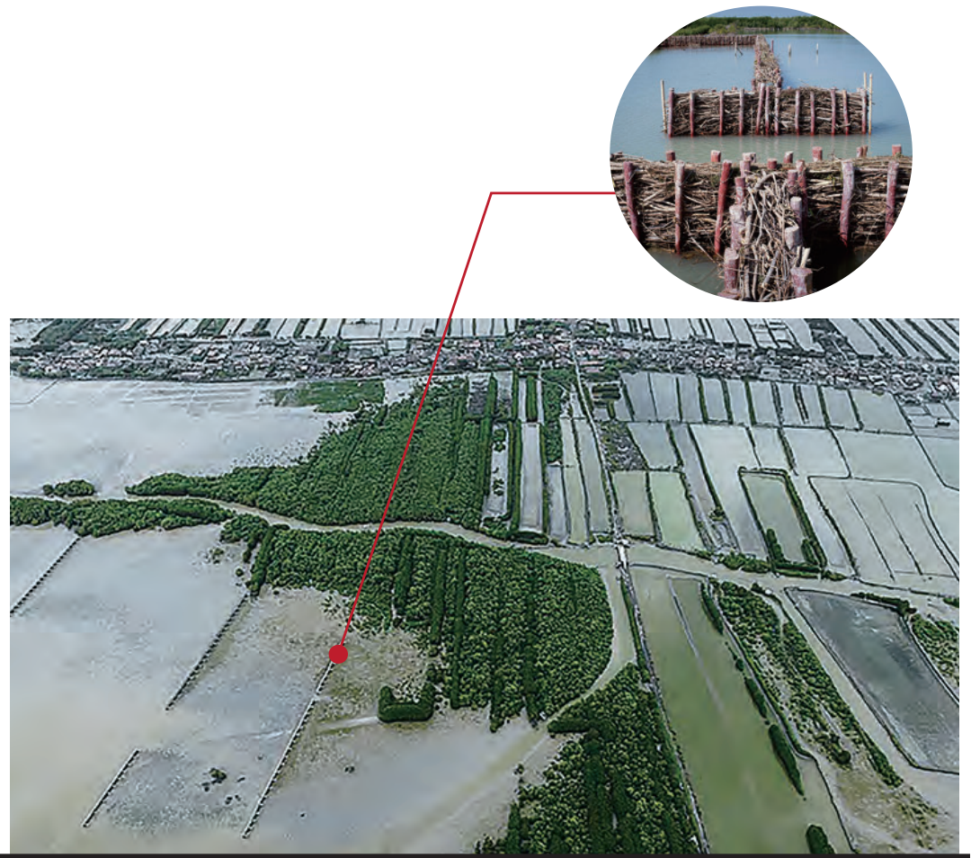
图 8 湿地国际（Wetlands International）推荐的透水消浪结构 2
