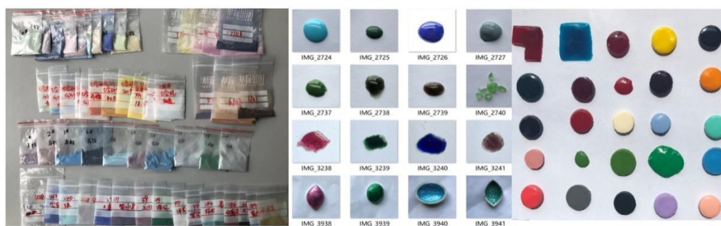
图1 部分测试所用的珐琅釉料和鎏彩原料
