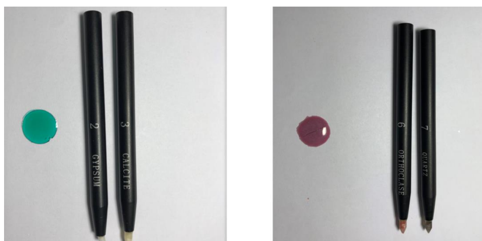
图14 部分珐琅和鑲彩的摩氏硬度测试图
