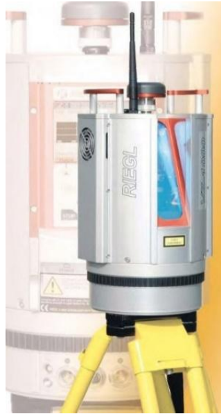
图 4.4 Riegl-VZ1000 三维激光扫描仪
