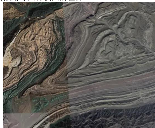
图B.3 褶皱构造遥感影像解译标志（二者均为光学影像）
