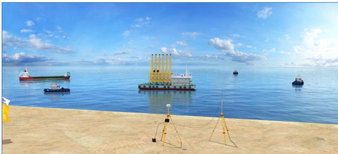
图 2.3-7 岸上 RTK-GPS 基站
